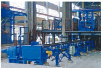
中国にて据付中の銅剥取機
