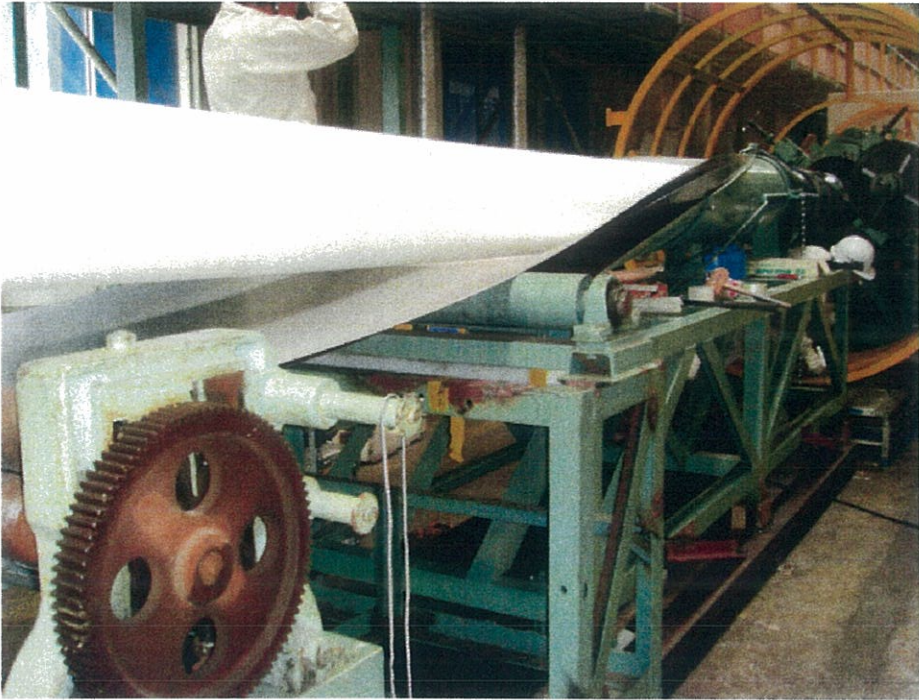
鉛テープ挿入工程
