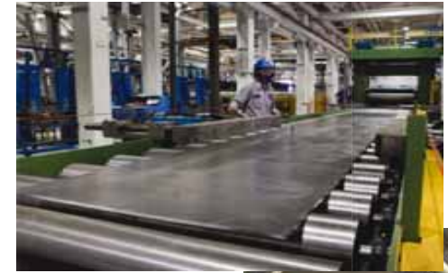
脱銅用 Pb-Sn-Ca アノード Quemetco 社工場にて
