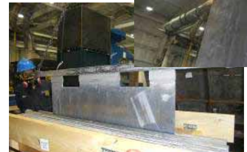
脱銅用 Pb-Sn-Ca アノード Quemetco 社工場にて
