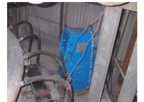
改善のためにスプリングハンマを取付けた例
