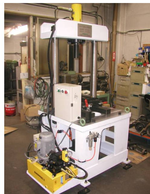
カウンターシャフト分解・圧入用プレス機
