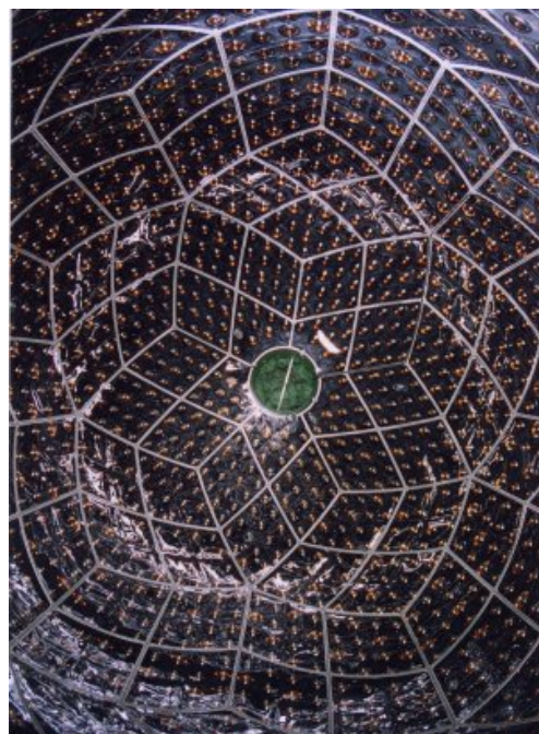
ステンレスタンク内の光電子増倍管装着状況
